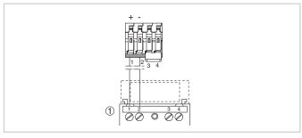
Schéma de raccordement boîtier à chambre unique
