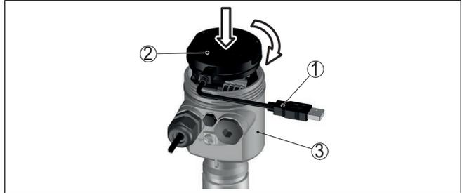
Fig. 24: Conexión del PC a través de adaptador de interface directamente en el sensor
