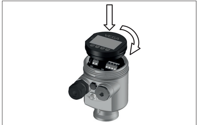
Fig. 20: Colocação do módulo de visualização e configuração na caixa de uma câmara no compartimento do sistema eletrônico
