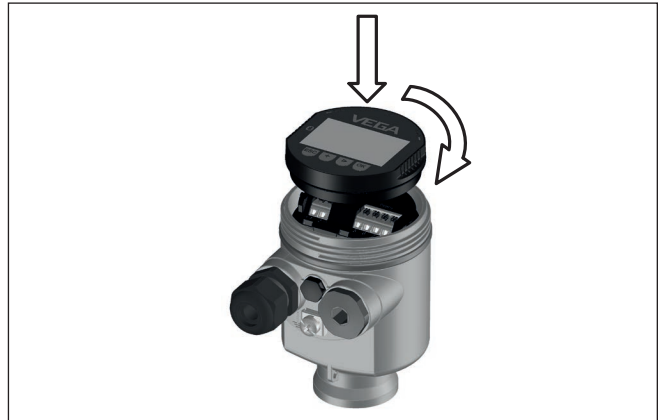
Fig. 13: Colocação do módulo de visualização e configuração na caixa de uma câmara no compartimento do sistema eletrónico
