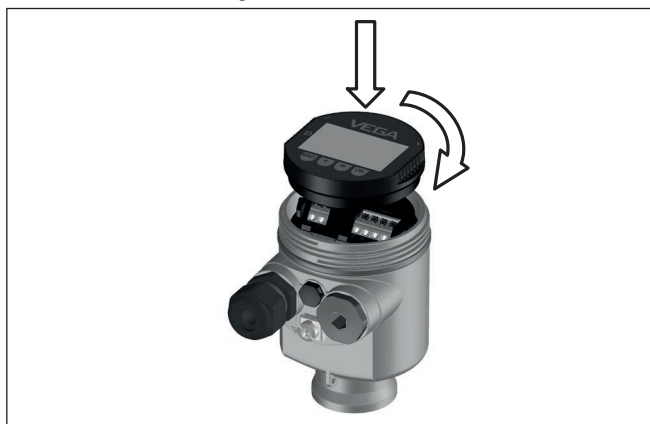
Figura 13: Inserimento del tastierino di taratura con display nel vano dell'elettronica in caso di custodia ad una camera
