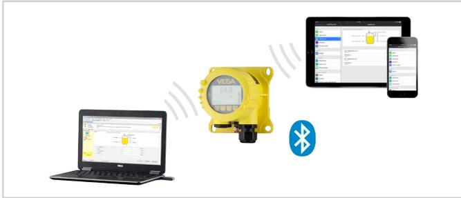
Conexión inalámbrica con instrumentos de configuración estándar
