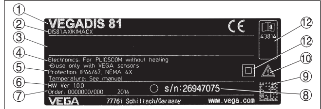
Fig. 1: Opbouw van de typeplaat (voorbeeld)
