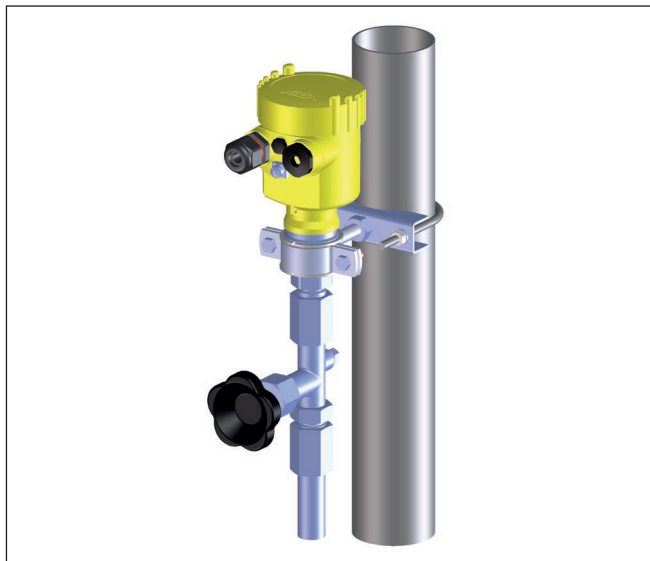
Figura 15: Esempio di montaggio di un supporto dell'apparecchio di misura
