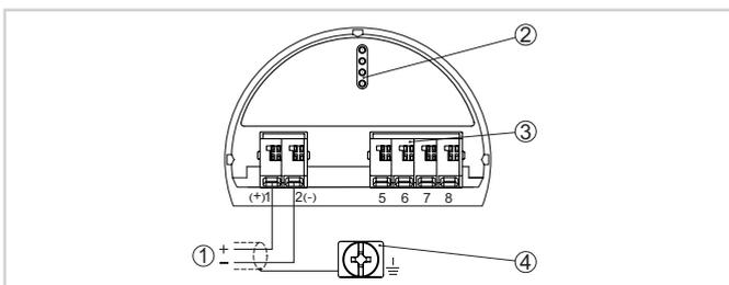
Collegamenti a morsetto secondari (apparecchi a sicurezza intrinseca)
