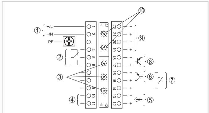
Terminais de conexão primários
