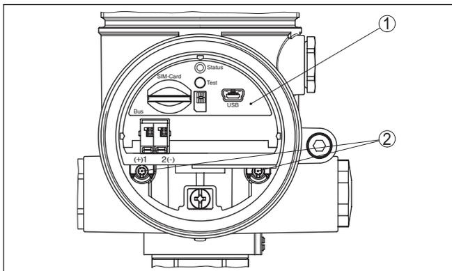
Figura 2: Vano di alimentazione con elettronica supplementare
