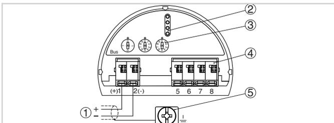
Elektronik- und Anschlussraum Einkammergehäuse
