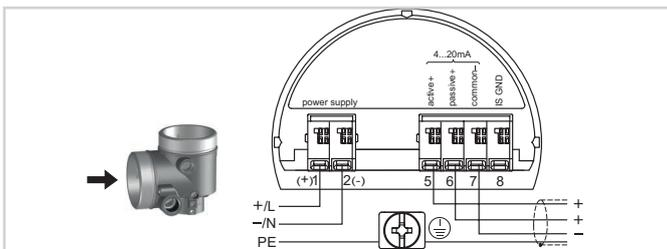
Anschlussraum Zweikammergehäuse - Netzspannung
