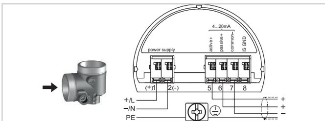
Compartimento de conexão da caixa e duas câmaras - tensão da rede
