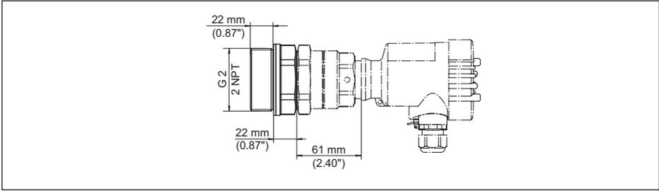
Abb. 39: Montageadapter mit Keramikabdeckung (optional) für VEGAMIP 62 mit innenliegender Hornantenne, Gewindeausführung G1½ mit PTFE-Abdeckung (auch mit 1½ NPT-Gewinde)
