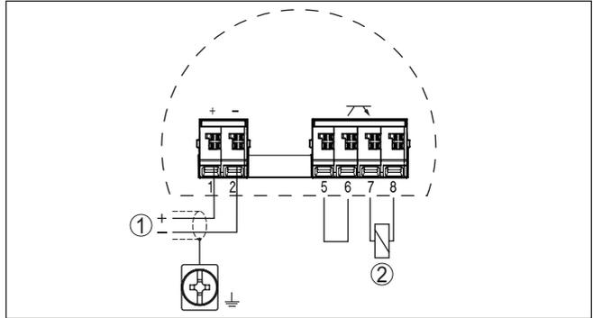
Abb. 26: Anschlussplan Auswerteeinheit - VEGAMIP 62 (Receiver) - PNP-Verhalten
