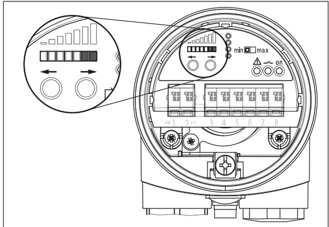
Abb. 31: LED-Anzeigeleiste - Einstellung für Füllgüter mit guter Signaldämpfung
