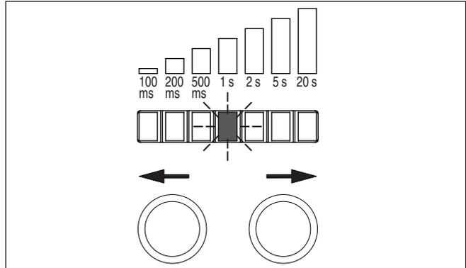
Abb. 33: Schaltverzögerung einstellen - LED-Anzeige blinkt
