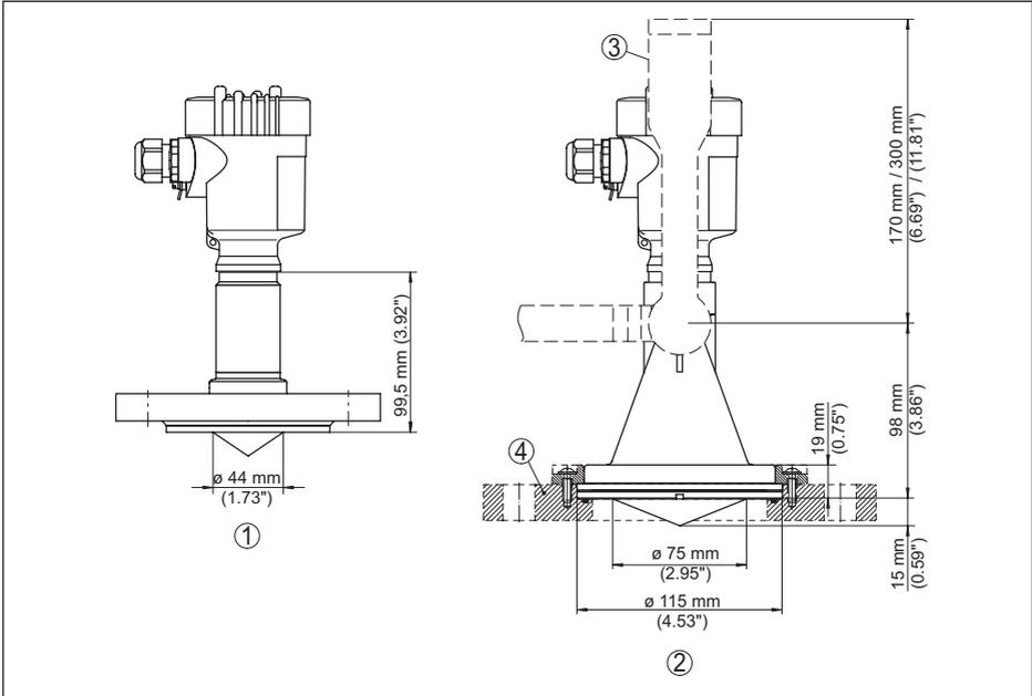
Abb. 37: VEGAMIP 62, gekapselte Antennen
