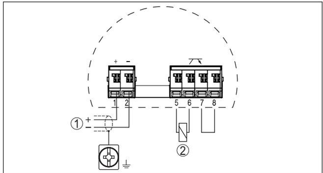
Abb. 27: Anschlussplan Auswerteeinheit - VEGAMIP 62 (Receiver) - NPN-Verhalten
