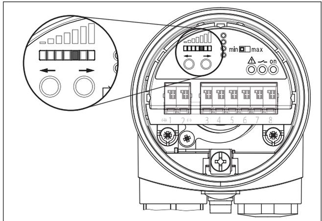
Abb. 32: LED-Anzeigeleiste - Einstellung für Füllgüter mit geringer Signaldämpfung
