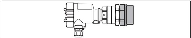
Abb. 3: VEGAMIP 62 mit keramischem Montageadapter "Abrasionsschutz" -40 ... +80 °C (-40 ... +176 °C)
