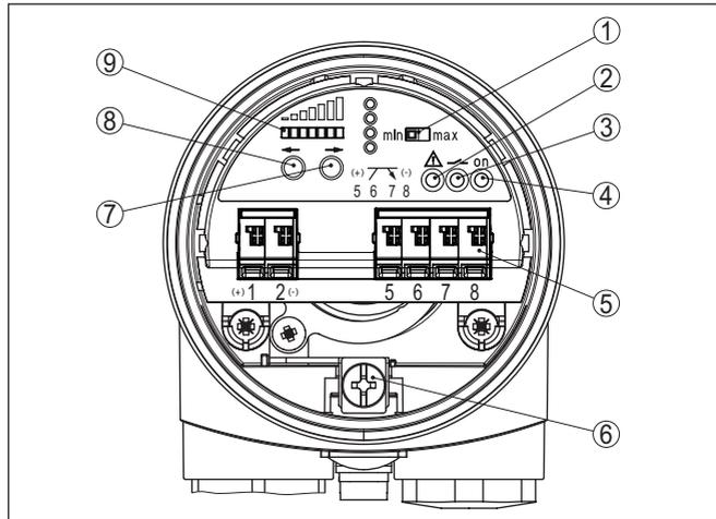
Abb. 29: Elektronikinsatz MP6X S (Empfängereinheit) - Transistorausgang
