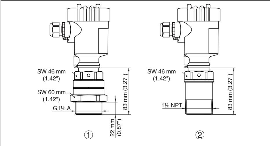
Abb. 36: VEGAMIP 62, innenliegende Hornantenne (Gewindeausführung)
