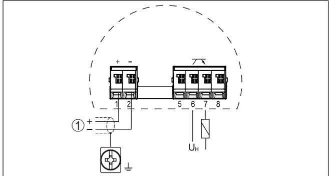
Abb. 28: Anschlussplan Auswerteeinheit - VEGAMIP 62 (Receiver) - Potenzialfrei
