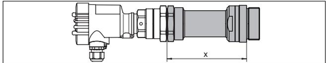
Abb. 14: VEGAMIP 62 mit Montageadapter "Hochtemperatur" -40 ... +450 °C (-40 ... +842 °F)
