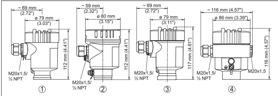
Abb. 34: Gehäuseausführungen, für Gerätegehäuse und externes Gehäuse
