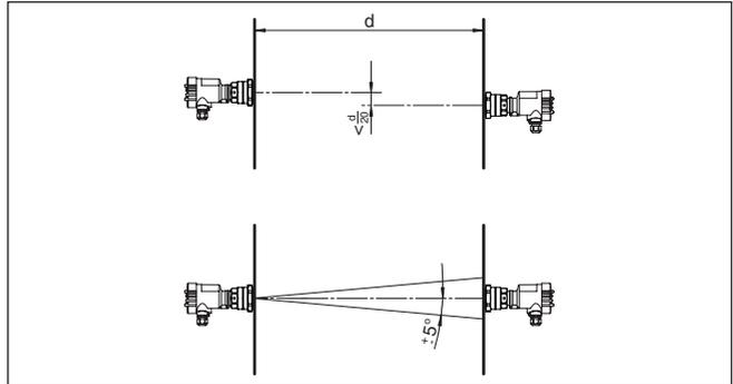
Abb. 17: Ausrichtung der Sensoren - Winkel und Achsenversatz
