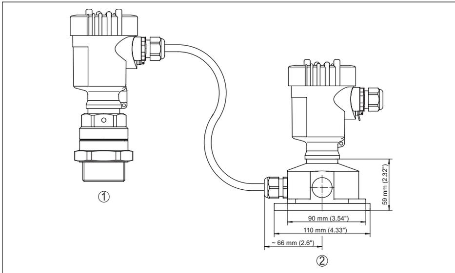
Abb. 35: Externes Gehäuse, Empfängereinheit
