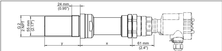
Abb. 41: Montageadapter mit Tubus (optional) für frontbündige Montage, für VEGAMIP 62 mit innenliegender Hornantenne, Gewindeausführung G1½ mit PTFE-Abdeckung (auch mit 1½ NPT-Gewinde)
