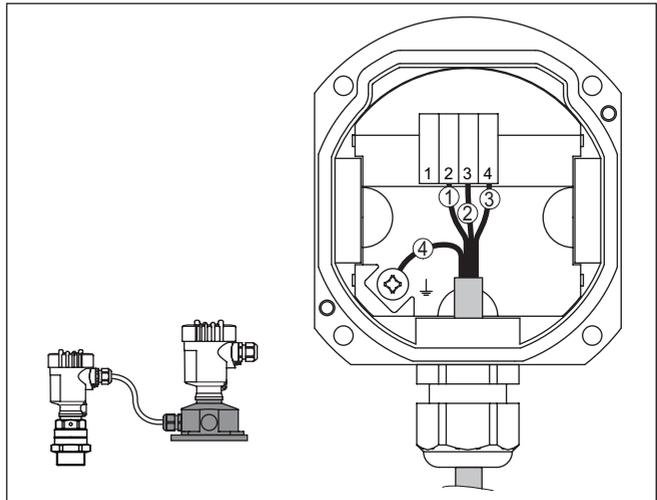
Abb. 23: Anschluss des Sensors im Gehäusesockel (externes Gehäuse)
