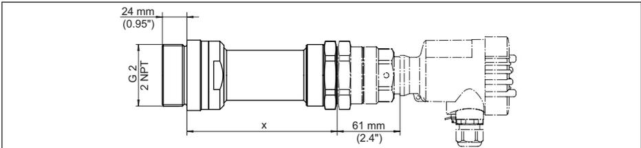
Abb. 40: Montageadapter mit Keramikabdeckung (optional) für VEGAMIP 62 mit innenliegender Hornantenne, Gewindeausführung G1½ mit PTFE-Abdeckung (auch mit 1½ NPT-Gewinde)
