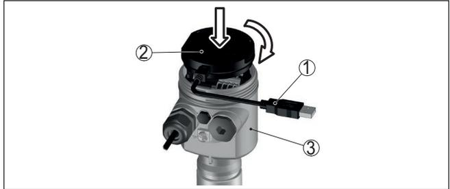
Fig. 22: Conexão do PC diretamente no sensor via adaptador de interface
