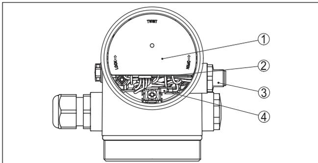
Fig. 14: Vue sur le compartiment de l'électronique avec l'adaptateur VEGADIS pour le raccordement de l'unité de réglage et d'affichage
