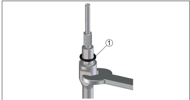
Fig. 29: Démontez la tige de mesure
