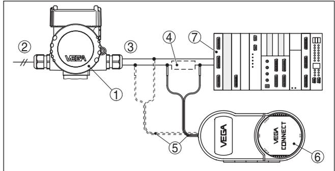
Fig. 23: Raccordement du PC à la ligne signal via HART
