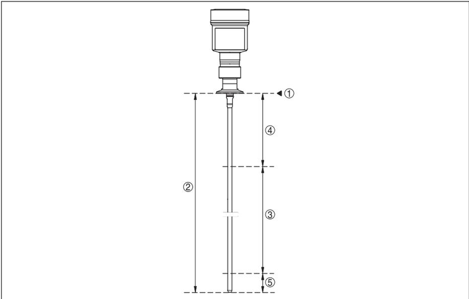
Fig. 31: Plages de mesure - VEGAFLEX 83
