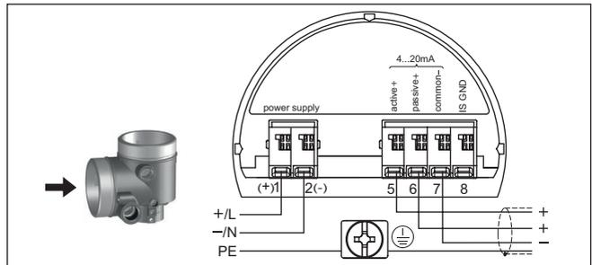
Fig. 12: Compartiment de raccordement boîtier deux chambres pour tension de réseau
