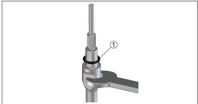
Fig. 28: Changer la tige de mesure
