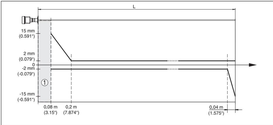
Fig. 32: Écart de mesure VEGAFLEX 83 en version tige dans l'eau
