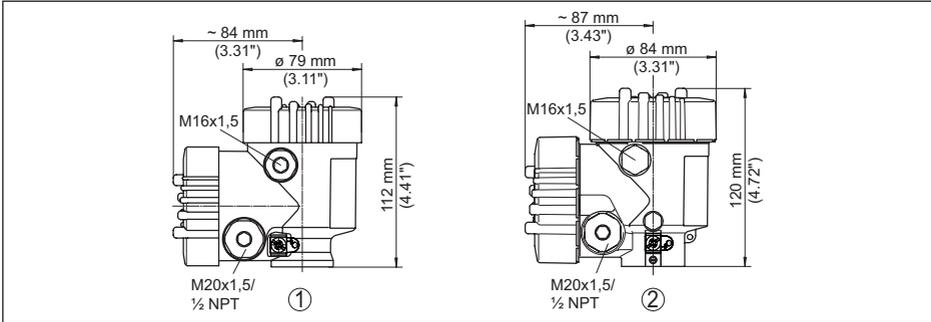
Fig. 35: Dimensions du boîtier (avec un module de réglage et d'affichage intégré, la hauteur du boîtier augmente de 9 mm/0.35 in)
