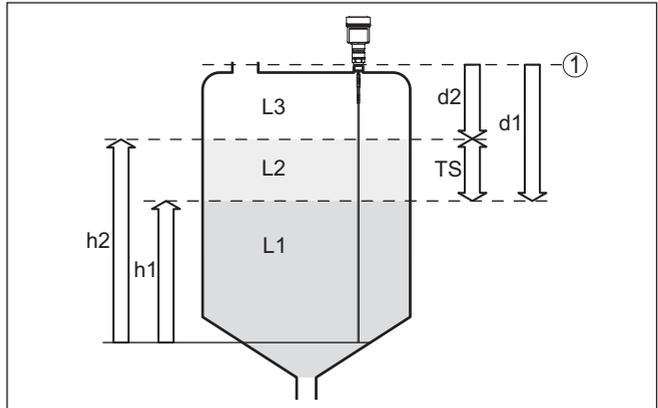
Fig. 3: Mesure d'interface
