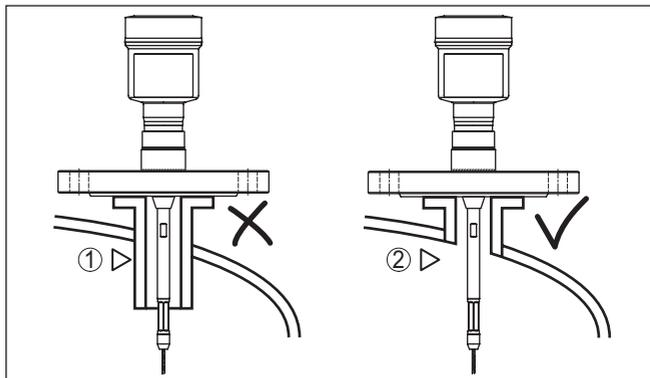
Fig. 7: Monter la rehausse de façon arasante
