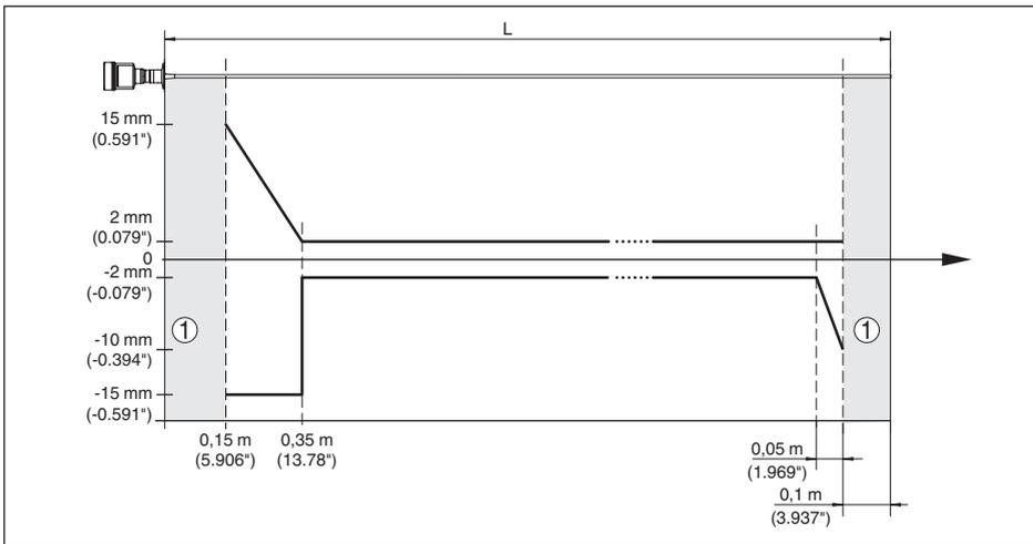
Fig. 33: Écart de mesure VEGAFLEX 83 en version tige dans l'huile
