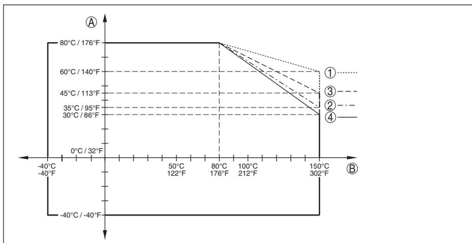
Fig. 34: Température ambiante - température process, version standard
