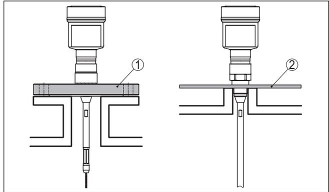
Fig. 5: Montage dans des cuves non métalliques
