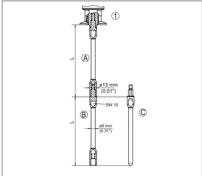
Fig. 38: Tiges de rallonge d'un diamètre de 8 mm (0.315 in)
