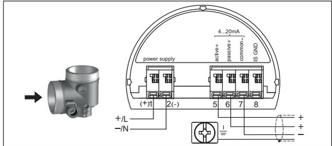
Fig. 13: Compartiment de raccordement boîtier deux chambres pour très basse tension
