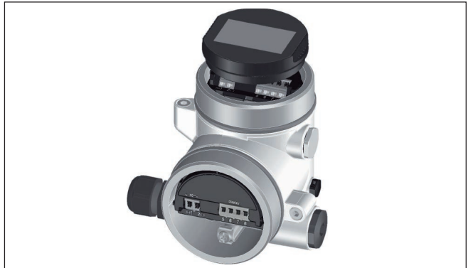
Abb. 16: Einsetzen des Anzeige- und Bedienmoduls beim Zweikammergehäuse
