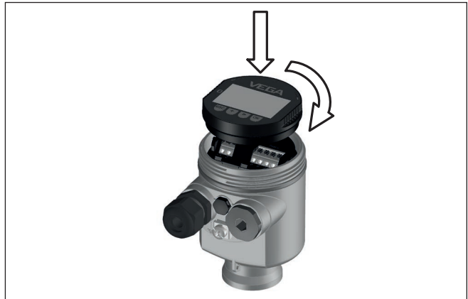
Rys. 21: Wkładanie modułu wyświetlającego i obsługowego do komory układu elektronicznego w obudowie jednokomorowej
