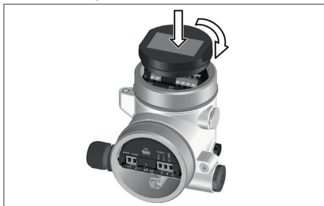
Fig. 17: Colocação do módulo de visualização e configuração
