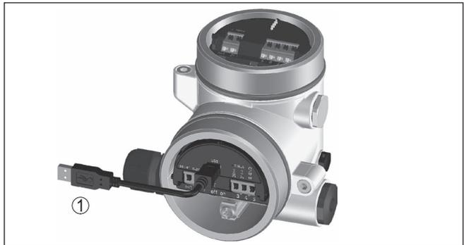
Figura 24: Collegamento del PC all'elettronica Modbus via USB
