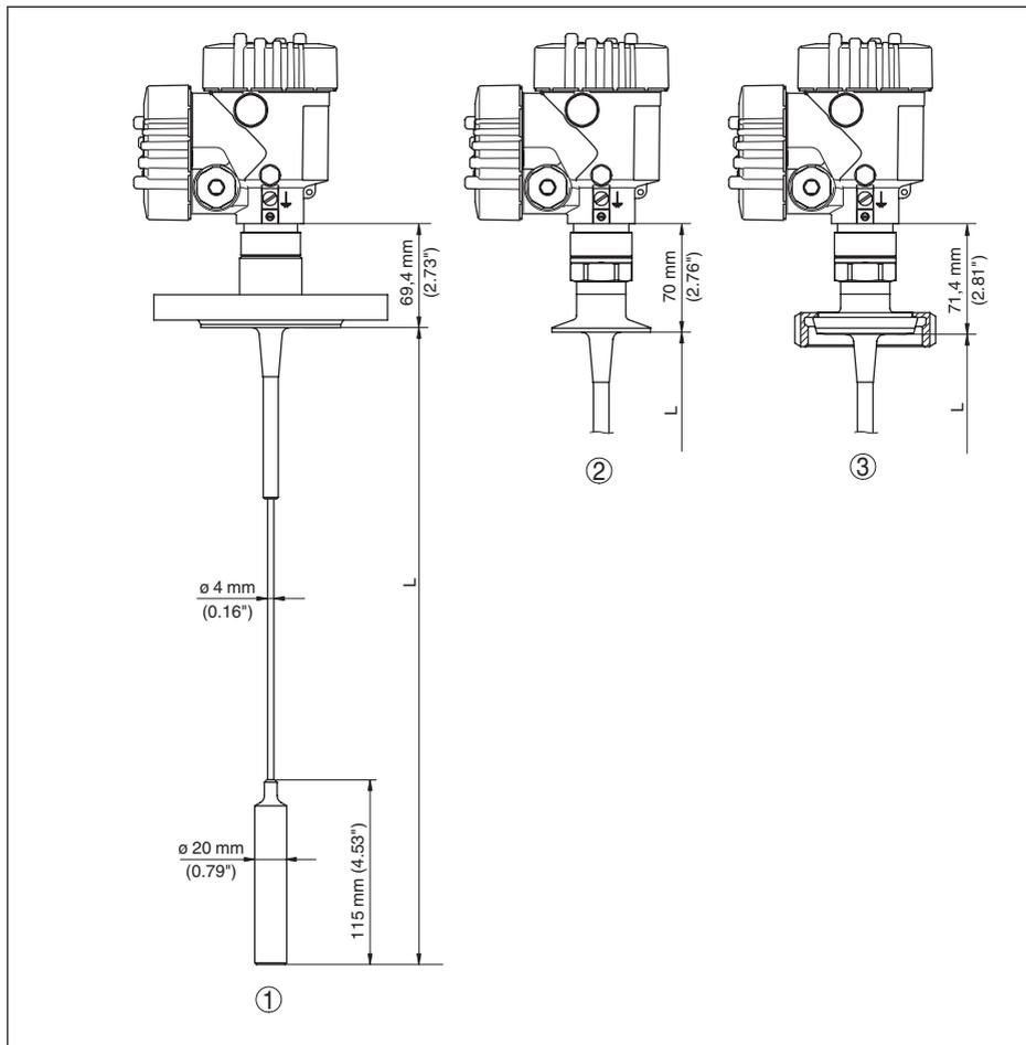
Fig. 38: VEGAFLEX 83, version câble avec poids tenseur
