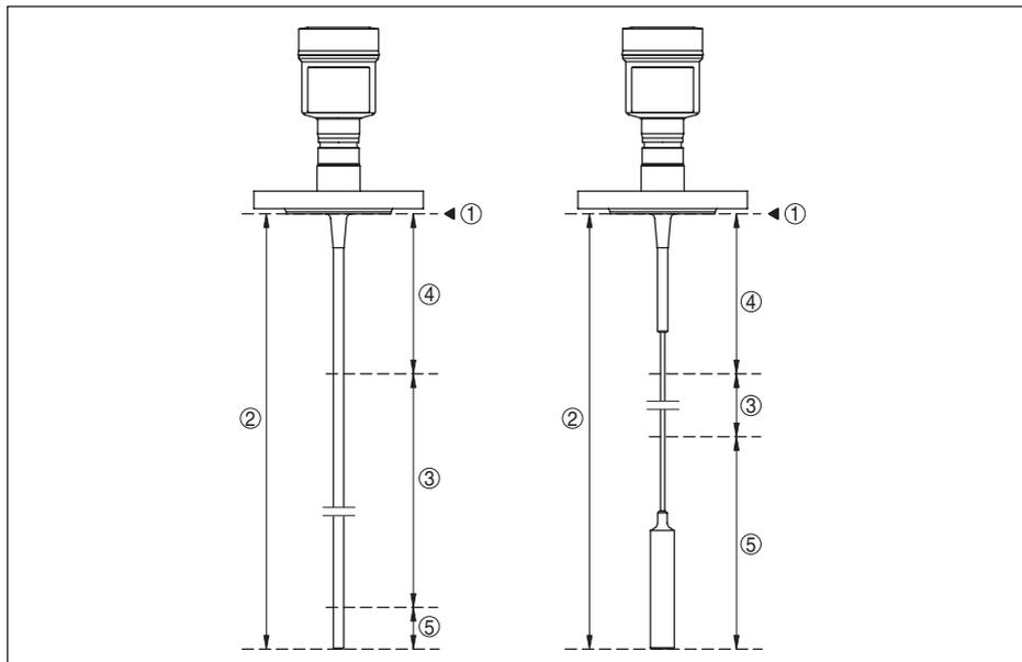
Fig. 30: Plages de mesure - VEGAFLEX 83
