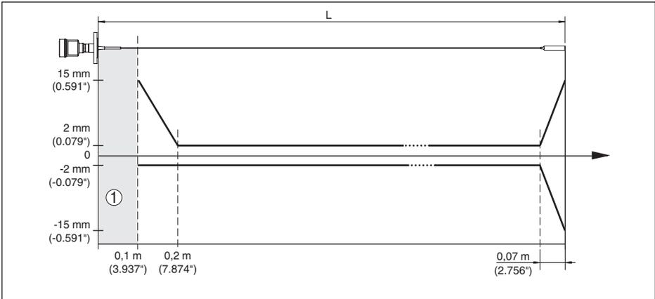
Fig. 33: Écart de mesure VEGAFLEX 83 en version câble (revêtu) dans l'eau
