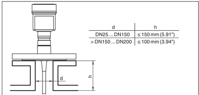
Fig. 7: Rehausse de montage
