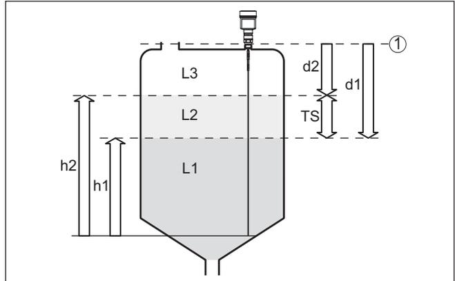
Fig. 4: Mesure d'interface
