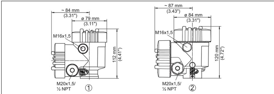
Fig. 37: Dimensions du boîtier (avec un module de réglage et d'affichage intégré, la hauteur du boîtier augmente de 9 mm/0.35 in)
