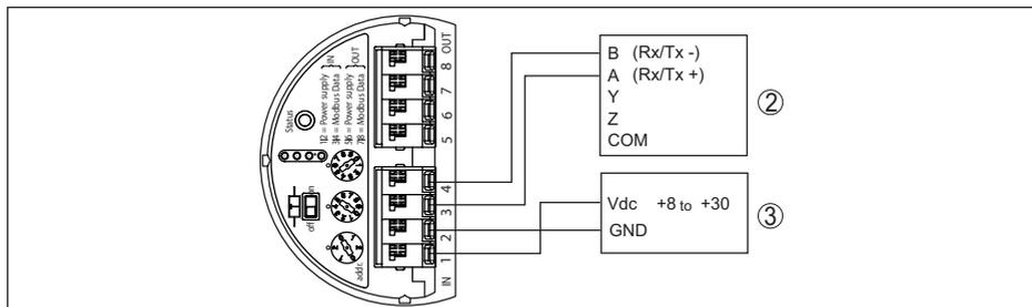
Fig. 36: Raccordement du VEGAFLEX 83 à RTU Fisher ROC 809
