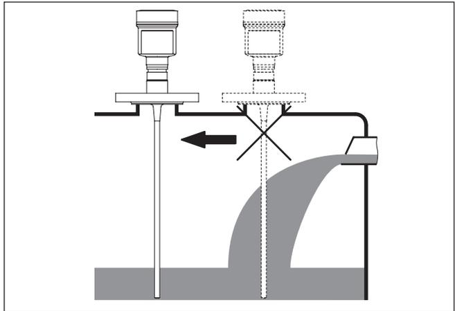
Fig. 9: Montage du capteur en présence d'un flux de produit
