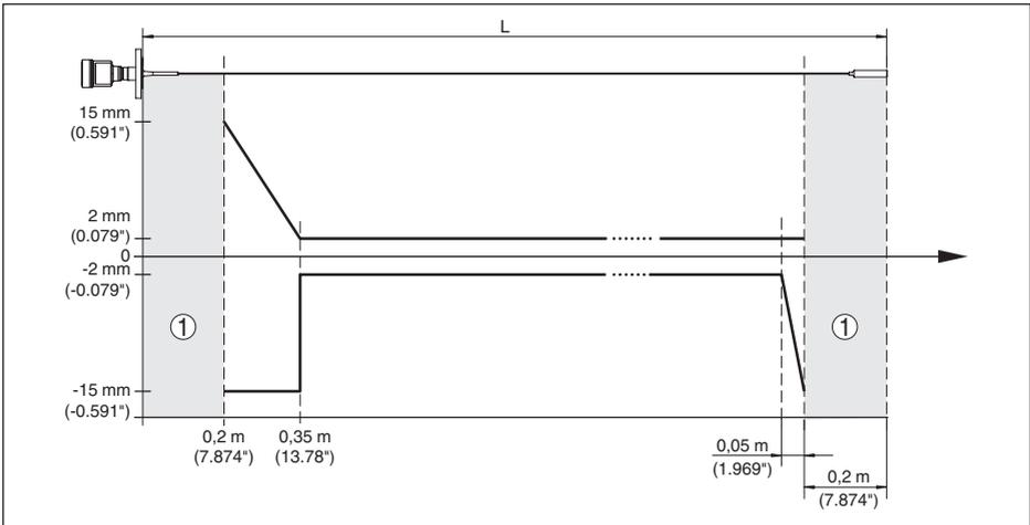
Fig. 34: Écart de mesure VEGAFLEX 83 en version câble (revêtu) dans l'huile
