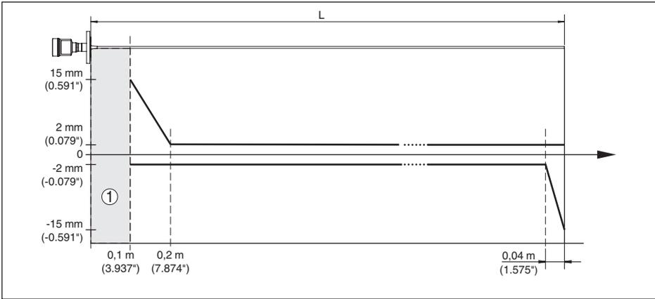
Fig. 31: Écart de mesure VEGAFLEX 83 en version tige (revêtue) dans l'eau
