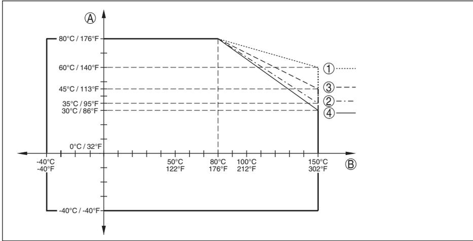
Fig. 35: Température ambiante - température process, version standard
