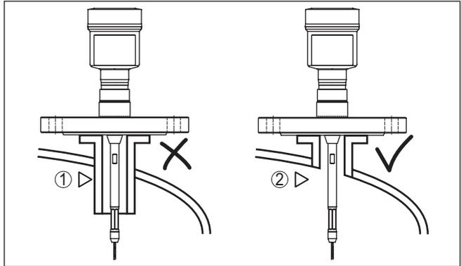
Fig. 8: Monter la rehausse de façon arasante
