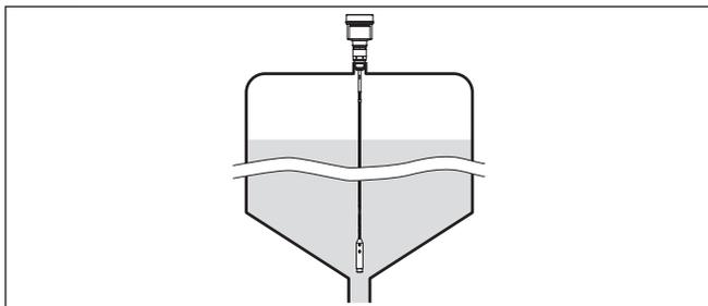
Fig. 5: Cuve à fond conique
