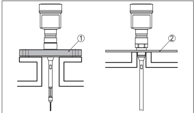
Fig. 6: Montage dans des cuves non métalliques
