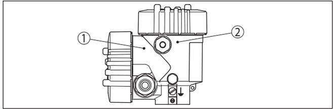
Fig. 12: Position du compartiment de raccordement (électronique du Modbus) et du compartiment de l'électronique (électronique du capteur)
