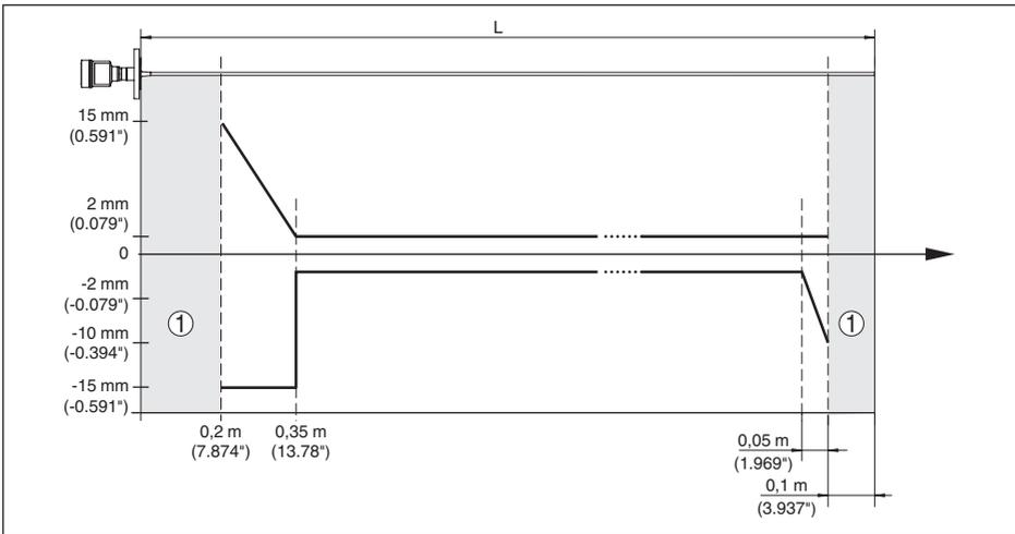
Fig. 32: Écart de mesure VEGAFLEX 83 en version tige (revêtue) dans l'huile
