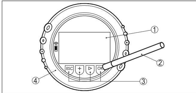
Fig. 19: Éléments de réglage et d'affichage - avec paramétrage par le stilet
