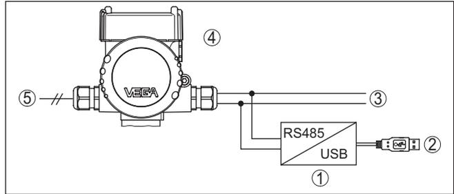
Fig. 25: Raccordement du PC à la ligne RS 485 via adaptateur d'interface
