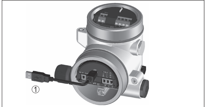
Res. 24: Bilgisayarın USB üzerinden Modbus elektroniğine bağlanması
