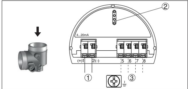
Fig. 15: Compartimento do sistema eletrônico - Caixa de duas câmaras Ex d ia
