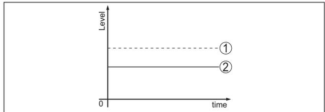
Fig. 33: A linha tracejada 1 mostra o nível de enchimento real, a linha contínua 2 mostra o nível de enchimento exibido pelo sensor
