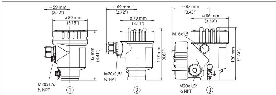
Fig. 43: Variantes da caixa com grau de proteção IP66/IP68 (0,2 bar), (com o módulo de visualização e configuração montado, a altura da caixa é aumentada em 9 mm/0,35 in)
