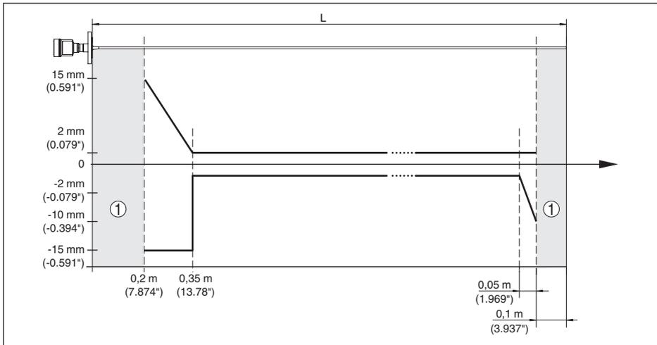
Fig. 36: Diferença de medição VEGAFLEX 83 em modelo com haste (revestida) com produto óleo
