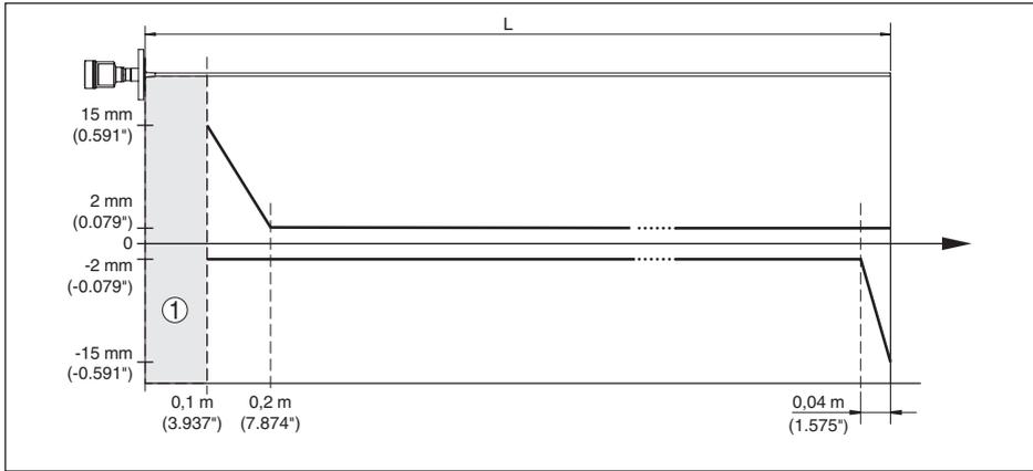
Fig. 35: Diferença de medição VEGAFLEX 83 em modelo com haste (revestida) com produto água
