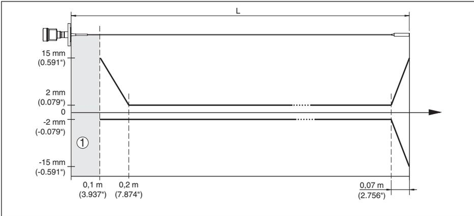
Fig. 37: Diferença de medição VEGAFLEX 83 em modelo com cabo de aço (revestido) com produto água
