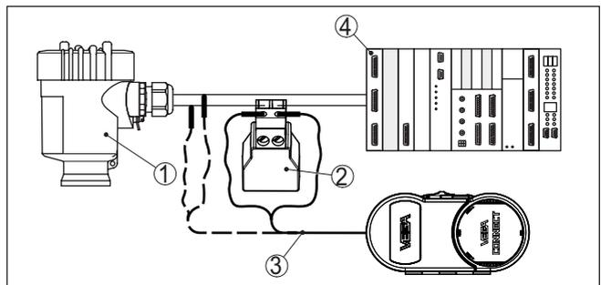
Fig. 29: Conexão do PC à linha de sinais via HART
