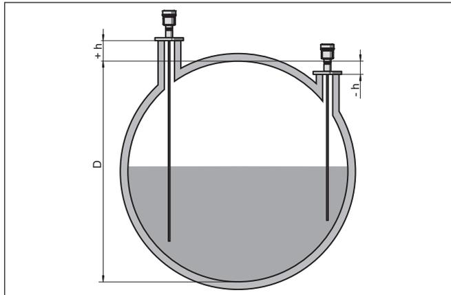
Fig. 25: Altura do reservatório e valor de correção da luva
