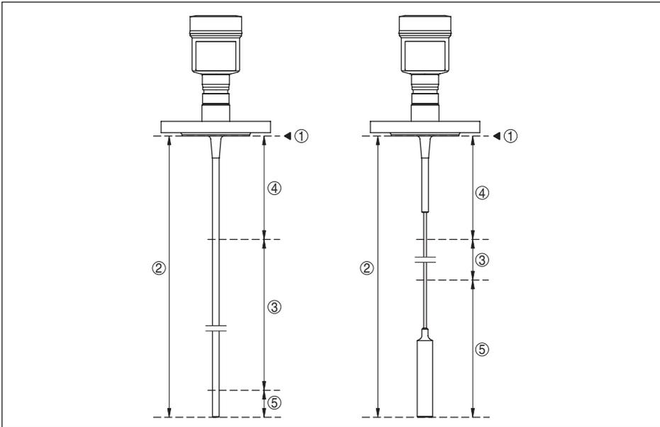
Fig. 34: Faixas de medição - VEGAFLEX 83
