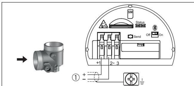
Fig. 14: Compartimento de conexão - módulo de rádio PLICSMOBILE 81
