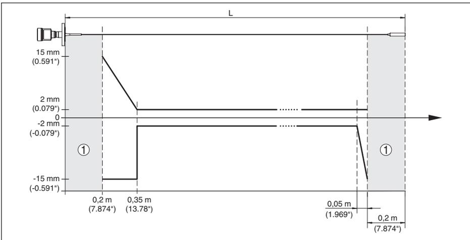
Fig. 38: Diferença de medição VEGAFLEX 83 em modelo com cabo (revestido) com produto óleo
