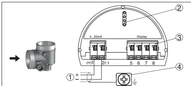
Fig. 13: Compartimento de conexão - Caixa de duas câmaras
