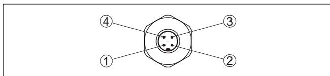
Fig. 18: Vista superior do conector de encaixe M12 x 1
