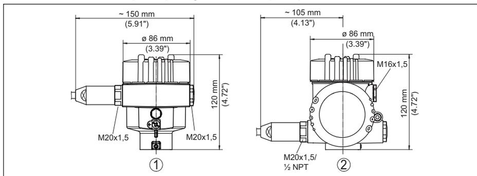
Fig. 42: Variantes da caixa com classe de proteção contra corpos estranhos e umidade IP66/IP68 (1 bar), (com módulo de visualização e configuração montado, a altura da caixa é aumentada em 9 mm/0,35 in)
