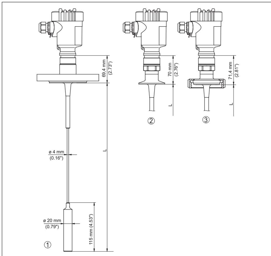
Fig. 45: VEGAFLEX 83, modelo com cabo de aço e peso tensor
