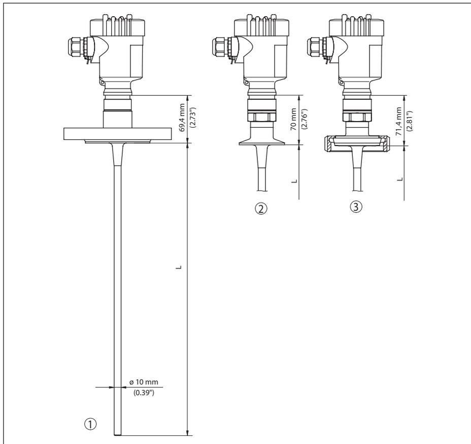
Fig. 46: VEGAFLEX 83, modelo com haste
