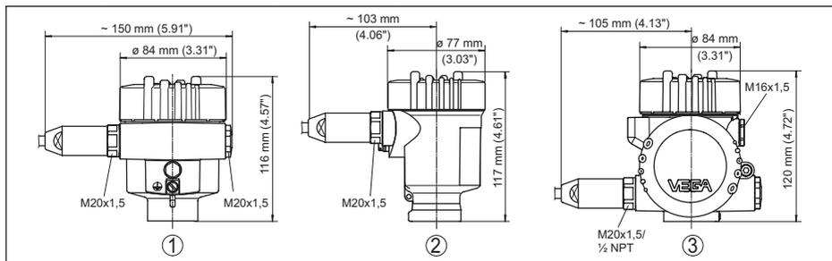
Fig. 44: Variantes da caixa com classe de proteção contra corpos estranhos e umidade IP66/IP68 (1 bar), (com módulo de visualização e configuração montado, a altura da caixa é aumentada em 9 mm/0,35 in)
