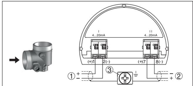
Fig. 20: Compartimento de conexão caixa de duas câmaras, sistema eletrônico adicional "saída de corrente adicional"
