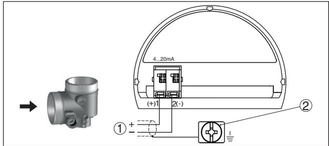
Fig. 16: Compartimento de conexão - Caixa de duas câmaras Ex d ia
