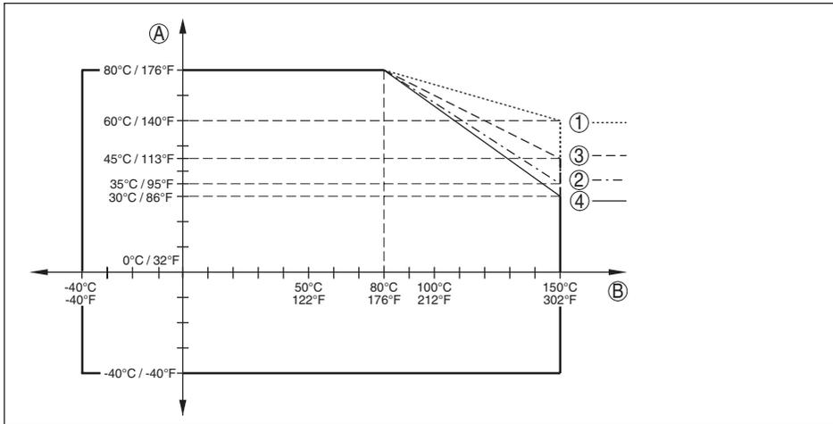
Fig. 39: Temperatura ambiente - Temperatura do processo, modelo padrão
