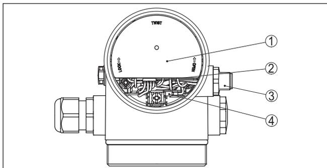
Fig. 17: Vista do compartimento do sistema eletrônico com adaptador do VEGADIS para a conexão da unidade externa de visualização e configuração
