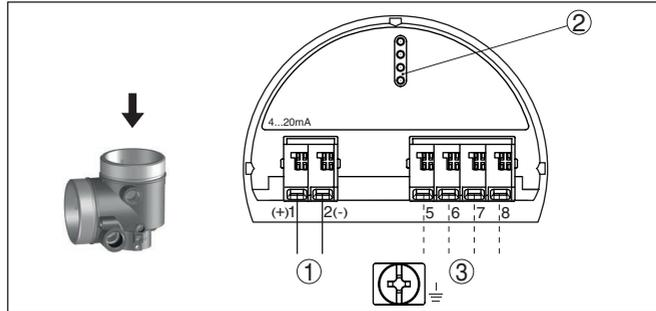
Fig. 15: Compartimiento de la electrónica - Carcasa de dos cámaras Ex d ia
