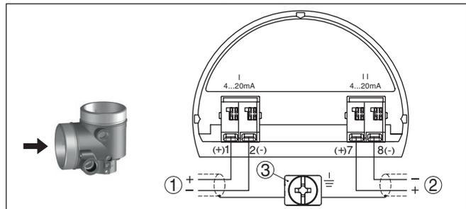
Fig. 20: Compartimento de conexiones carcasa de dos cámaras, electrónica adicional "Salida de corriente adicional"
