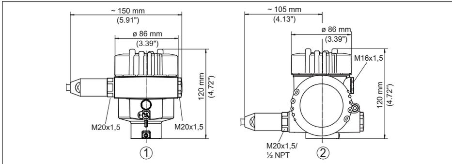
Fig. 42: Variantes de carcasa en grado de protección IP66/IP68 (1 bar), (con módulo de visualización y configuración integrado aumenta la altura de la carcasa en 9 mm/0.35 in)
