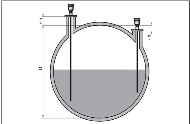
Fig. 25: Altura del depósito y valor de corrección de tubuladura
