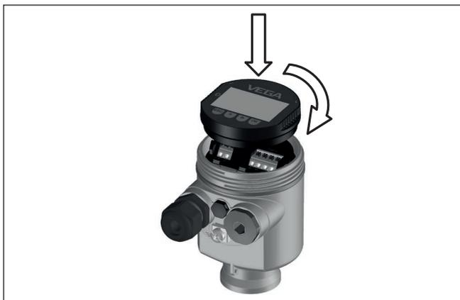
Fig. 21: Empleo del módulo de visualización y configuración en carcasa de una sola cámara el compartimento de conexión
