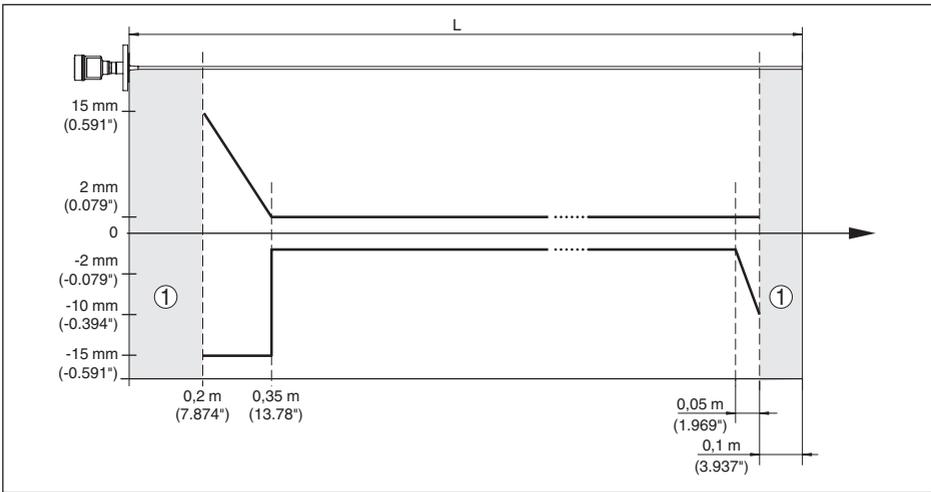
Fig. 36: Error de medición VEGAFLEX 83 en versión de varilla (recubierta) en aceite
