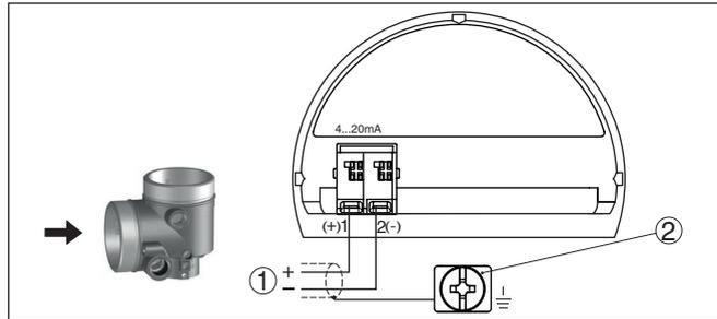
Fig. 16: Compartimiento de conexiones - Carcasa de dos cámaras Ex d ia
