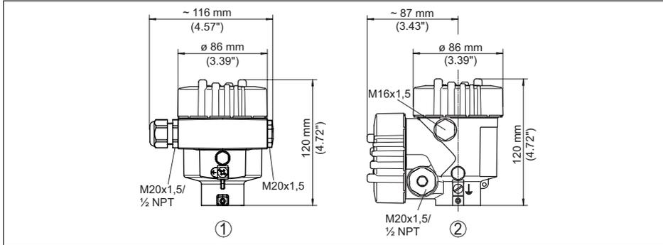
Fig. 41: Variantes de carcasa en grado de protección IP66/IP68 (0,2 bar), (con módulo de visualización y configuración integrado aumenta la altura de la carcasa en 9 mm/0.35 in)
