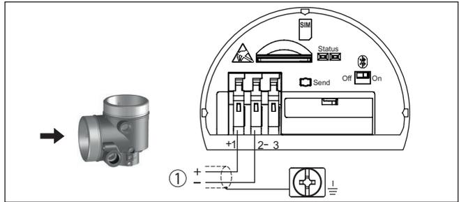
Fig. 14: Compartimiento de conexiones - módulo de radio PLICSMOBILE 81
