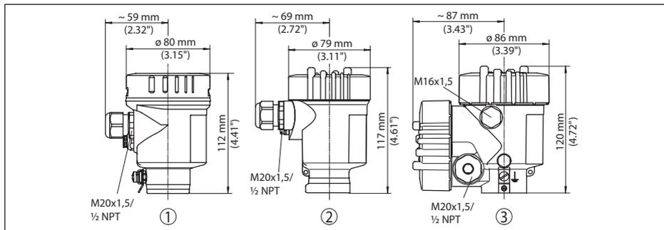
Fig. 43: Variantes de carcasa en grado de protección IP66/IP68 (0,2 bar), (con módulo de visualización y configuración integrado aumenta la altura de la carcasa en 9 mm/0.35 in)
