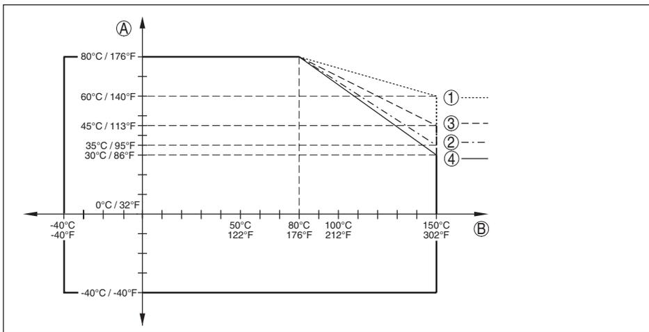
Fig. 39: Temperatura ambiente - Temperatura de proceso, versión estándar
