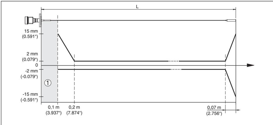
Fig. 37: Error de medición VEGAFLEX 83 en versión cableada (recubierta) en agua
