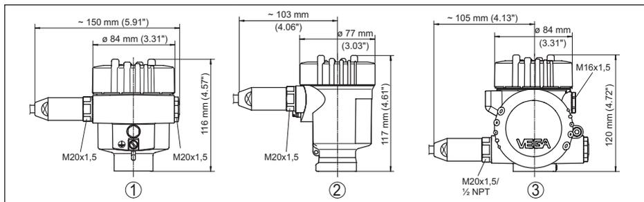
Fig. 44: Variantes de carcasa en grado de protección IP66/IP68 (1 bar), (con módulo de visualización y configuración integrado aumenta la altura de la carcasa en 9 mm/0.35 in)
