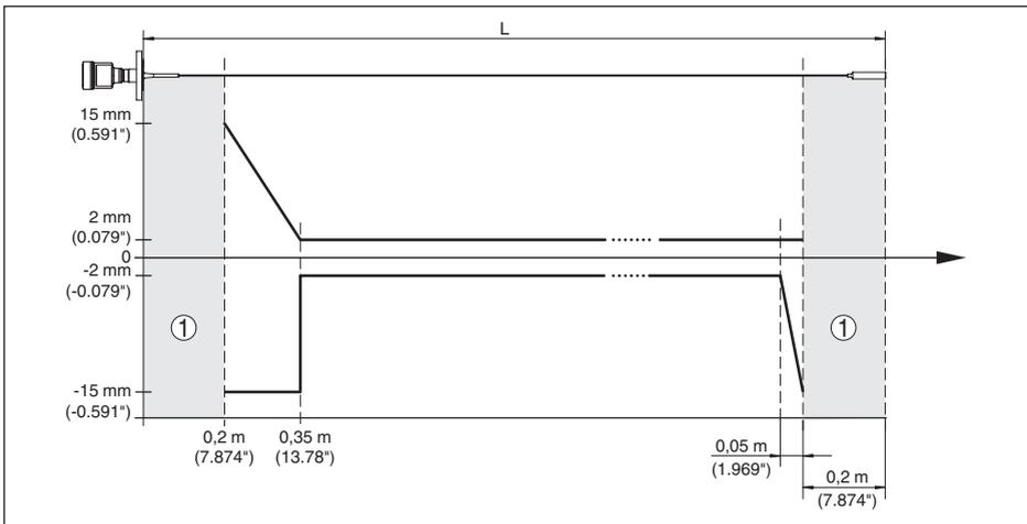
Fig. 38: Error de medición VEGAFLEX 83 en versión cableada (recubierta) en aceite
