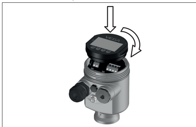
Figura 20: Inserimento del tastierino di taratura con display nel vano dell'elettronica in caso di custodia ad una camera
