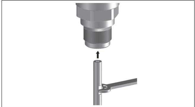
Fig. 30: Cambiar cable de medición y varilla de medición
