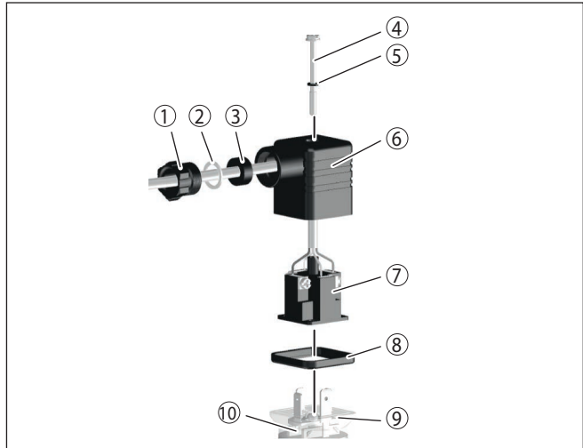
Fig. 8: Conexión enchufe de válvula ISO 4400
