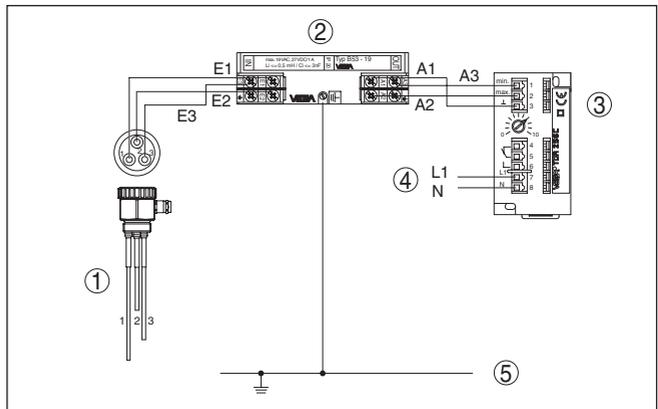
Fig. 9: Esquema de conexión B53-19 con sonda de medición conductiva de tres varillas
