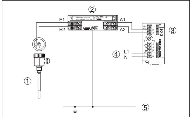
Fig. 8: Esquema de conexión B53-19 con sonda de medición conductiva de una varilla
