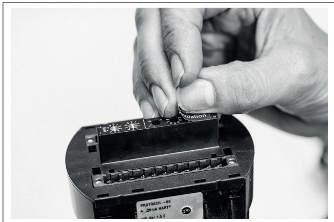
Rys. 2: Magistrala Profibus PA - ściągnąć folię ochronną znajdującą się nad przelącznikami do wybierania adresu
