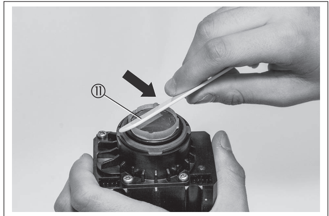
Fig. 14: Trek de tweede zijde van de optical pad af met de kunststof spatel 11 Kunststof spatel
