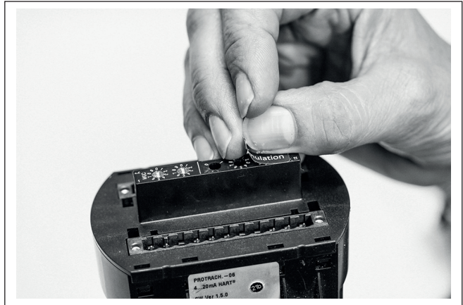
Fig. 2: Profibus PA - afdekkfolie van de adresinstelschakelaars aftrekken
