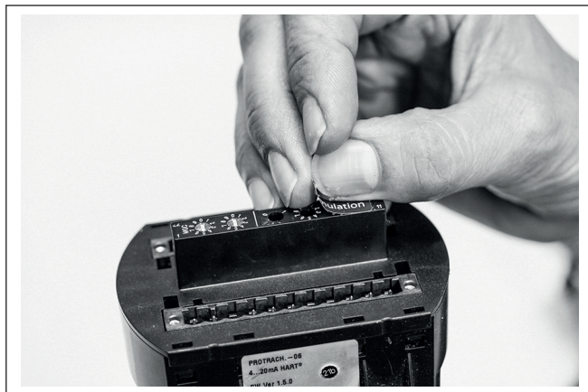
Figura 2: Profibus PA - rimuovere la pellicola protettiva dai selettori di indirizzo
