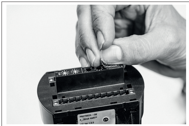
Fig. 2: Profibus PA - Retirer la feuille de protection des boutons de sélection d'adresse
