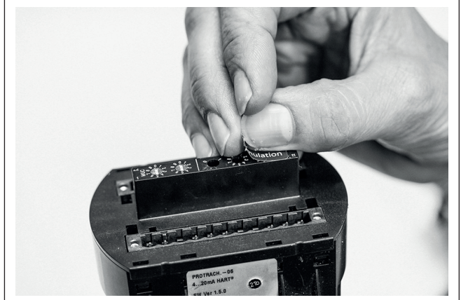
Res. 2: Profibus PA - Adres komut anahtarları üzerindeki koruyucu folyoyu çıkarın
