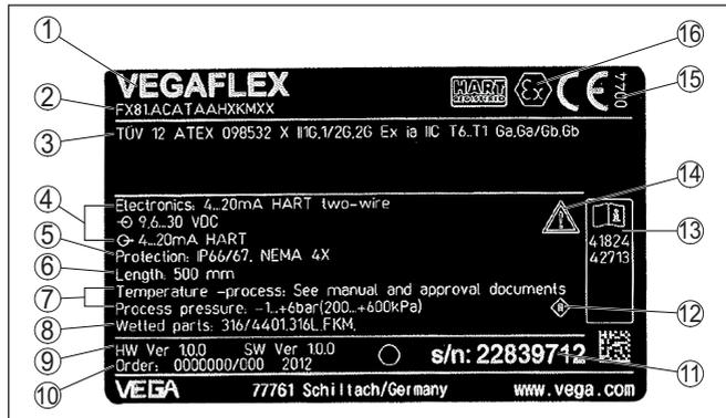
Fig. 1: Présentation de la plaque signalétique (exemple)
