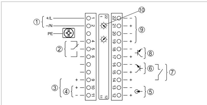
Terminais de conexão primários
