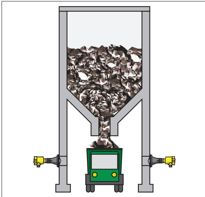
Figura 14: Rilevamenti di oggetti in un impianto di caricamento di autocarri
