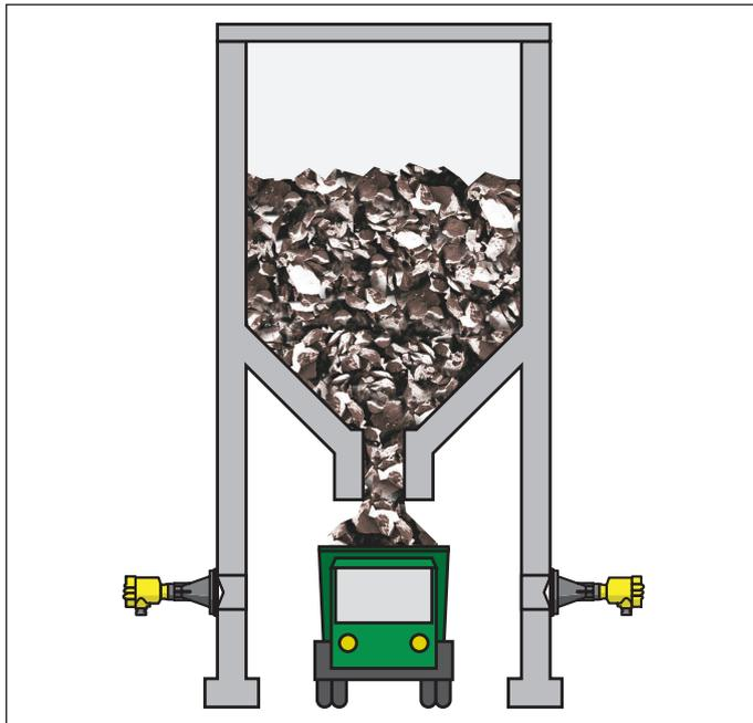
Fig. 9: Détection d'objets sur une installation de chargement d'un poids lourd
