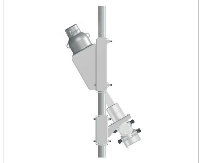
Res. 38: 50 ... 100 mm (1.97 ... 3.94 in)'lik borulara çapraz ilaveler için dirsek
