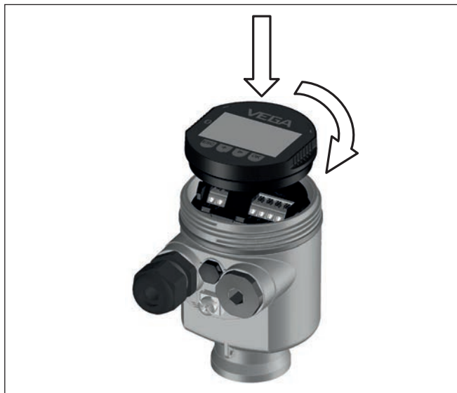
Figura 14: Inserimento del tastierino di taratura con display nel vano dell'elettronica in caso di custodia ad una camera
