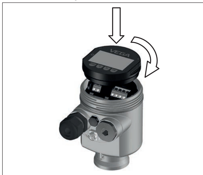
Figura 34: Inserimento del tastierino di taratura con display nel vano dell'elettronica in caso di custodia ad una camera
