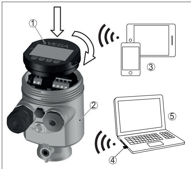
Rys. 2: Bezprzewodowe połączenie ze standardowymi komunikatorami
