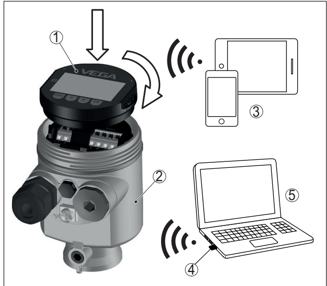
Fig. 2: Conexión inalámbrica con instrumentos de configuración estándar
