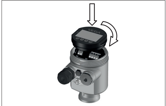
Fig. 3: Plaatsen van de display- en bedieningsmodule bij eenkamerbehuizing in elektronaruimte.
