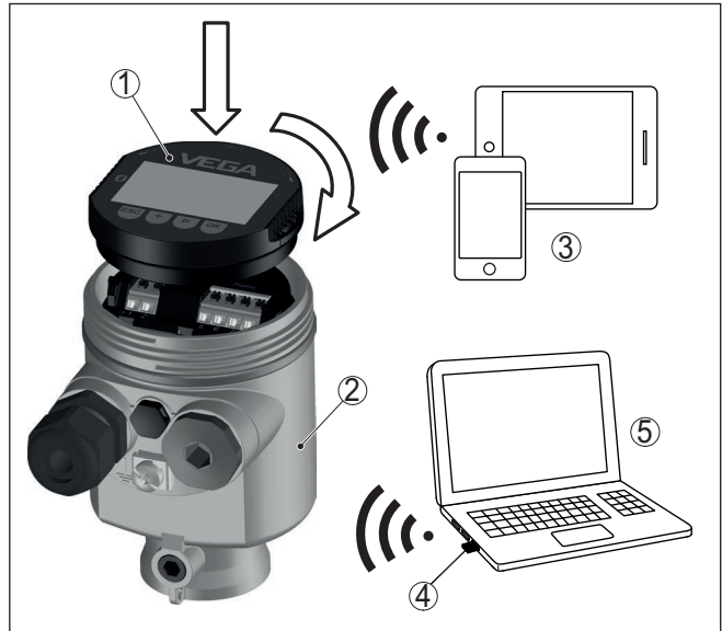
Fig. 2: Draadloze verbinding met standaard verbindingen
