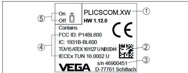
Fig. 1: Présentation de la plaque signalétique (exemple)
