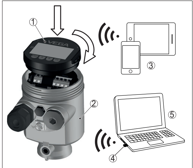
Abb. 2: Drahtlose Verbindung zu Standard-Bediengeräten
