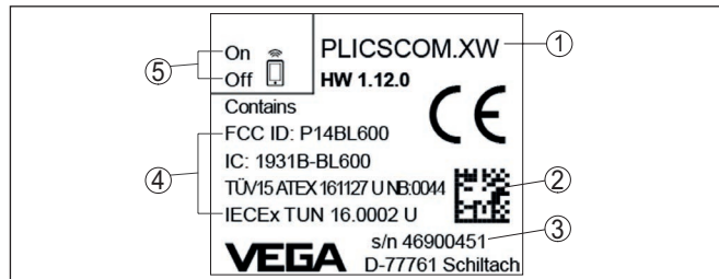
Abb. 1: Aufbau des Typschildes (Beispiel)
