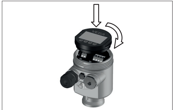
Abb. 3: Einsetzen des Anzeige- und Bedienmoduls beim Einkammergehäuse im Elektronikraum
