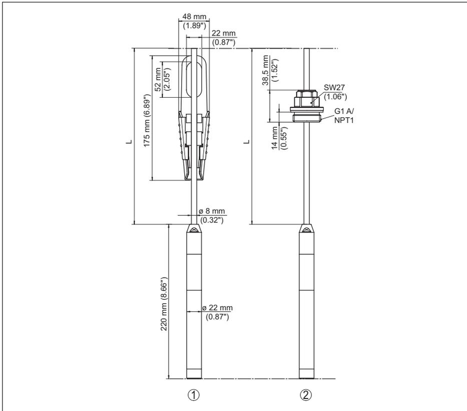
Fig. 20: VEGAWELL 52, avec capteur de mesure 316L/titane 22 mm
