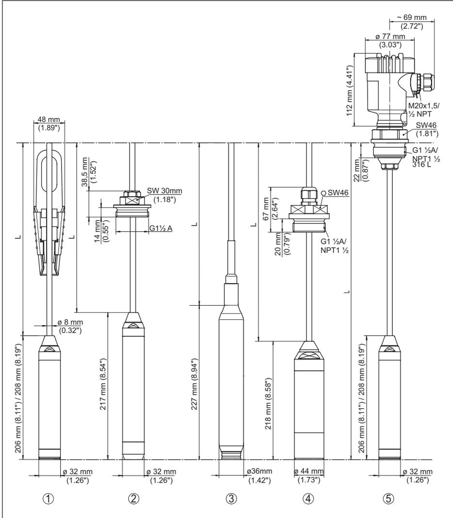
Fig. 22: VEGAWELL 52, avec capteur de mesure acier Duplex (1.4462)/PVDF
