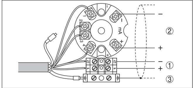
Fig. 12: Schéma de raccordement via VEGABOX 02 avec convertisseur intégré pour Pt 100
