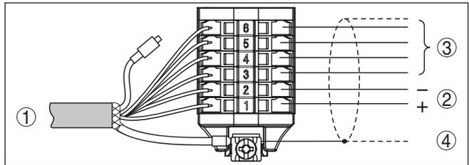
Fig. 11: Schéma de raccordement VEGAWELL 52 pour 4 ... 20 mA/HART Pt 100
