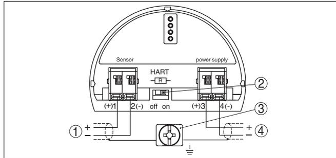
Fig. 14: Schéma de raccordement VEGAWELL 52 4 ... 20 mA/HART
