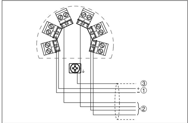
Fig. 13: Schéma de raccordement VEGAWELL 52 pour 4 ... 20 mA/HART Pt 100
