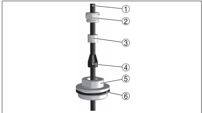
Fig. 7: Structure du bouchon fileté pour câble porteur
