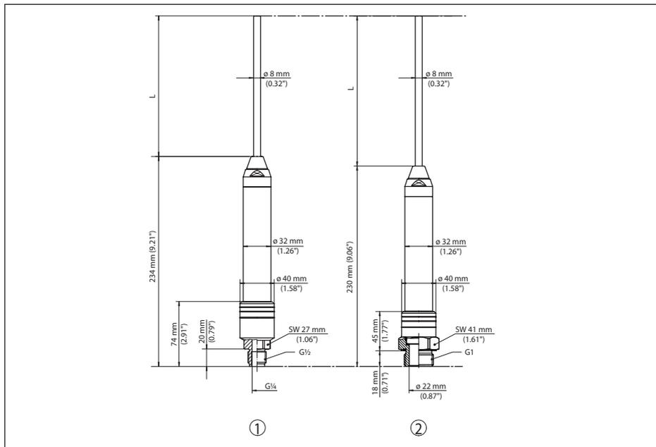
Fig. 23: VEGAWELL 52, avec raccord fileté et capteur de mesure acier Duplex (1.4462)
