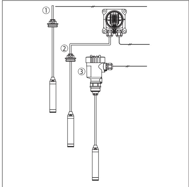
Fig. 9: Raccordement du VEGAWELL 52 à l'alimentation
