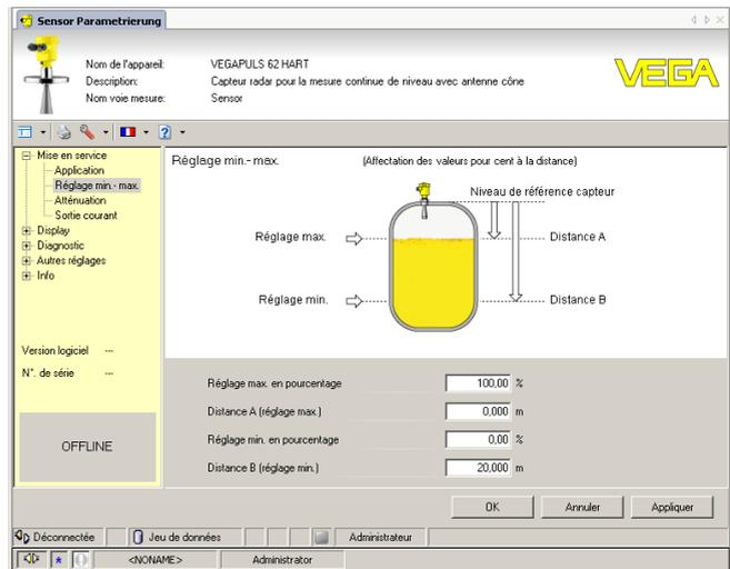
Fig. 17: Exemple de masque DTM
