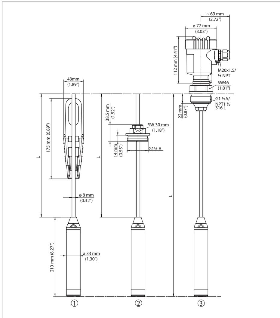
Fig. 21: VEGAWELL 52, avec capteur de mesure titane 33 mm
