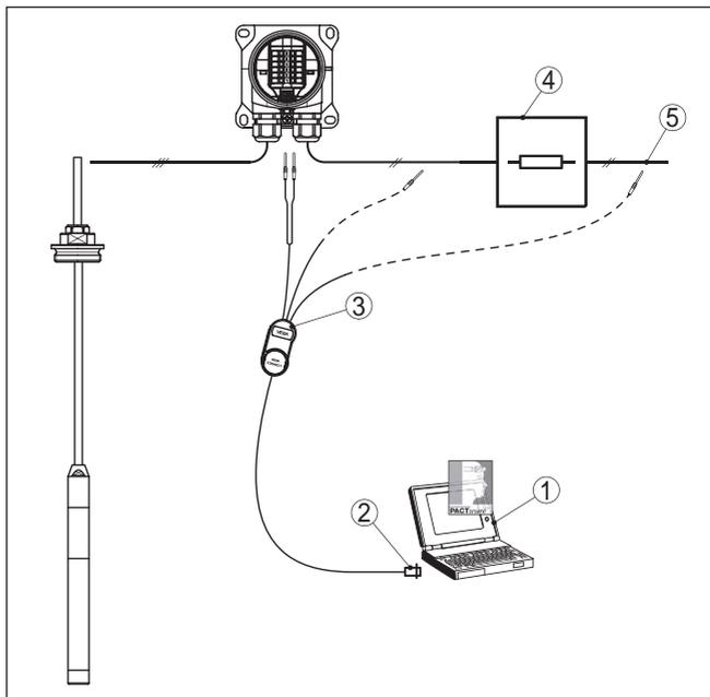
Fig. 16: Raccordement du PC à la VEGABOX 03 ou à la résistance de communication
