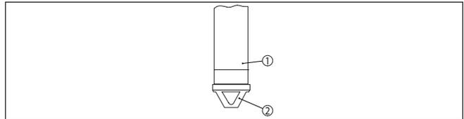
Fig. 4: VEGAWELL 52, protection de transport et de montage
