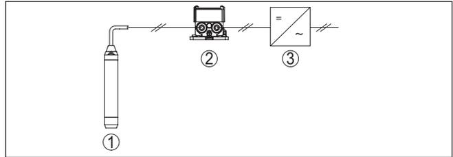
Fig. 15: Raccordement du VEGADIS 82 au capteur, paramétrage via le module de réglage et d'affichage
