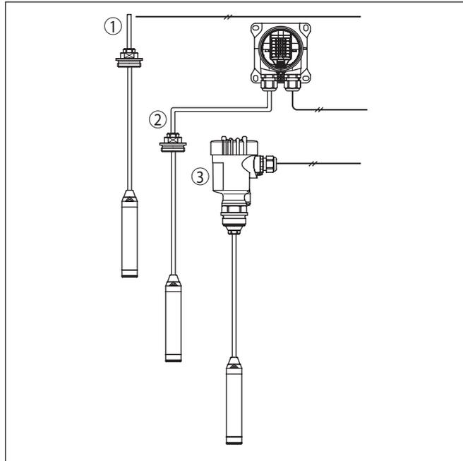
Figura 9: Collegamento del VEGAWELL 52 alla tensione d'alimentazione
