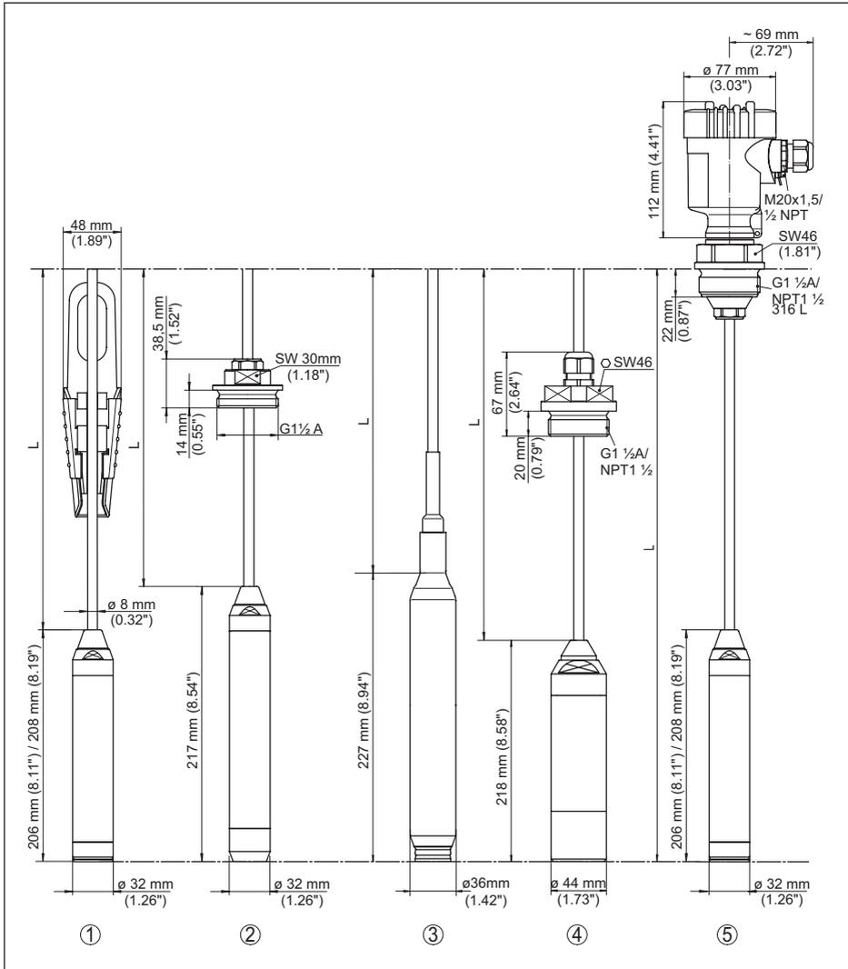
Figura 18: VEGAWELL 52, con elemento primario di misura acciaio inox duplex (1.4462)/PVDF
