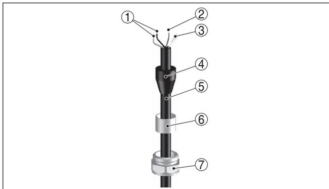
Figura 15: Struttura della guarnizione del cavo
