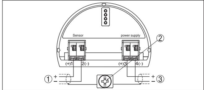
Figura 13: Schema di allacciamento VEGAWELL 52 per sensori 4 ... 20 mA
