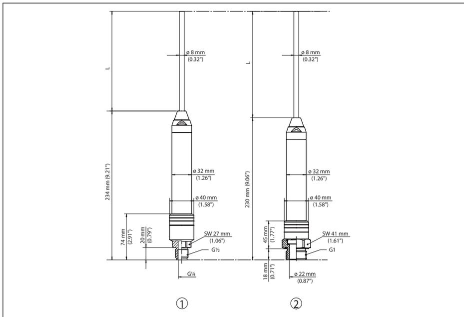
Figura 19: VEGAWELL 52, con attacco filettato ed elemento primario di misura acciaio inox duplex (1.4462)
