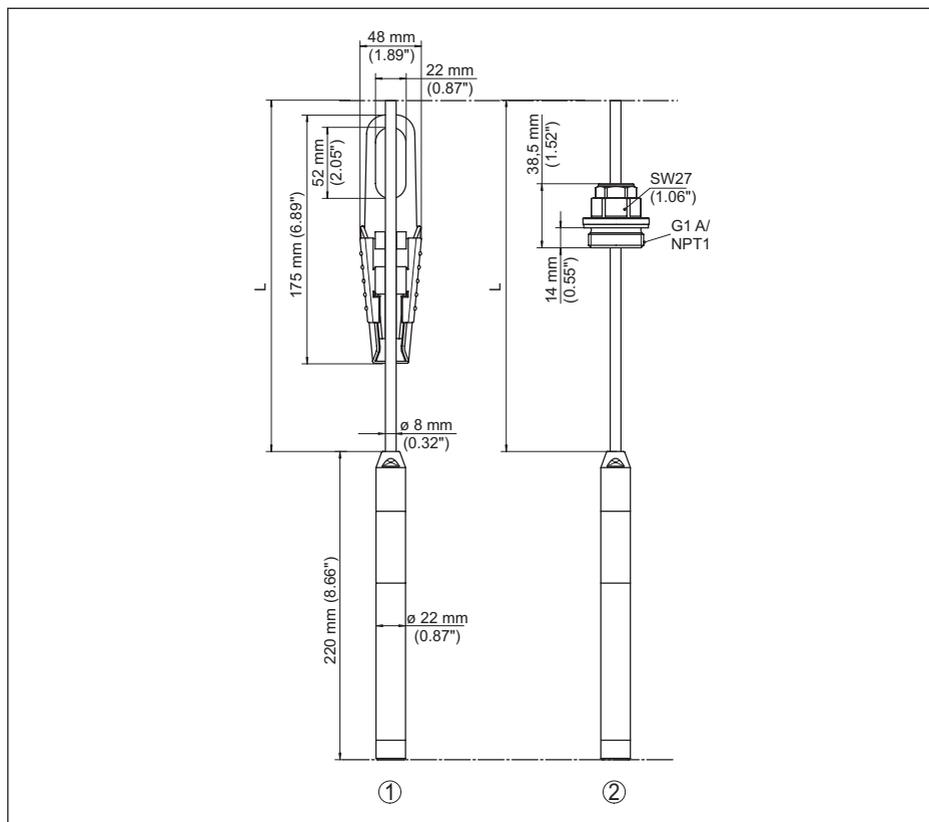
Figura 16: VEGAWELL 52, con elemento primario di misura 316L/titanio 22 mm
