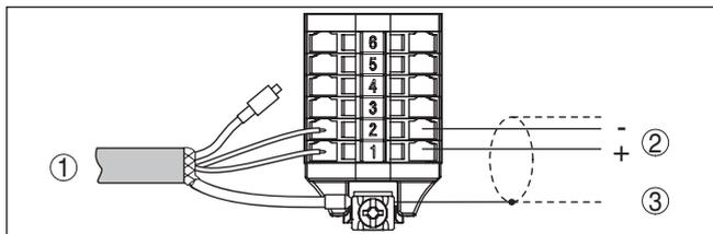
Figura 11: Schema di allacciamento VEGAWELL 52 4 ... 20 mA, 4 ... 20 mA/ HART
