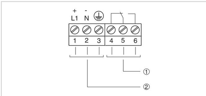
Electrónica con salida de relé
