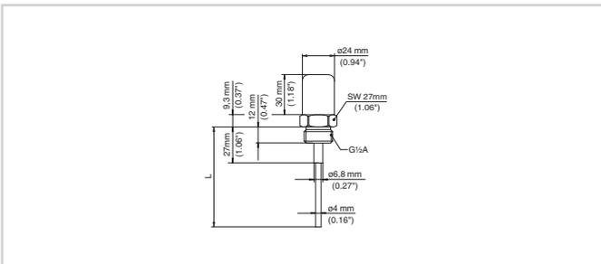
Sonde de mesure résistive EL 8
